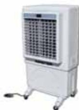
I raffrescatori Master raffrescano l'aria utilizzando un semplice processo naturale: l'evaporazione dell'acqua diminuisce la temperatura dell'aria. Una pompa prende l'acqua da un serbatoio che umidifica un grande filtro in cellulosa naturale. Un potente ventilatore aspira l'aria attraverso il filtro. L'acqua evapora dal filtro e diminuisce la temperatura dell'aria di diversi gradi. L'aria esce pulita e fresca nell'ambiente.
