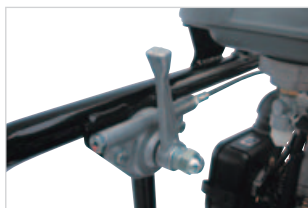
Leva acceleratore originale Mikasa in alluminio pressofuso
