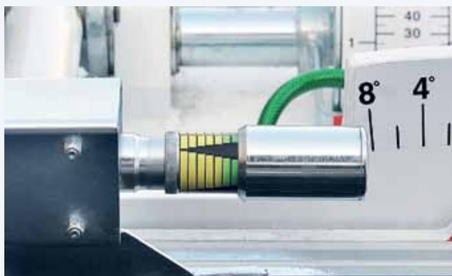
Differenti colori ed una scala grafica (per coloro che hanno difficoltà a distinguere i colori) indicano in modo facile ed univoco se la velocità di lavoro può essere aumentata, se è ottimale o se è al limite del blocco per sovraccarico.
