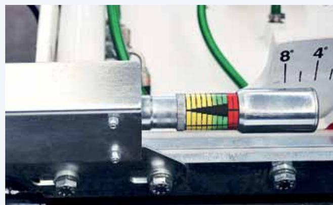
La scala graduata si posiziona automaticamente sulla pressione massima di taratura della macchina motrice.
